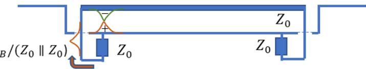
電圧波は電極を伝搬して上流端の  $Z_0$  で無反射で吸収
