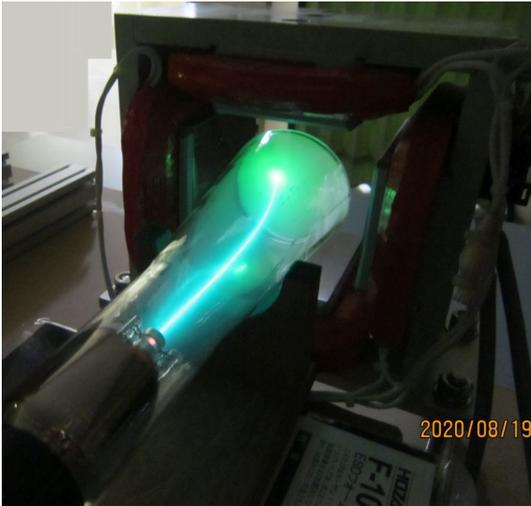
図 1: クルックス管は立派な電子加速器です
