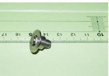
周波数特性を改善するためガラスフィードスルーを使用したボタン電極の例。SMAコネクタ。
