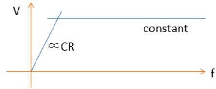
図 13: ピックアップ電極の周波数特性のイメージ。
