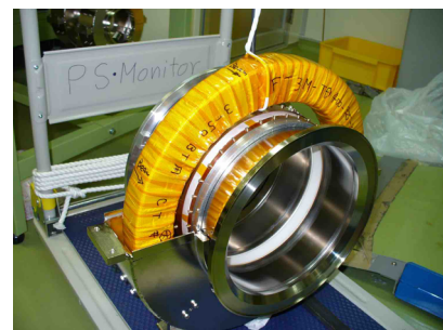
Fig. 3 Current transformer の内部構造
