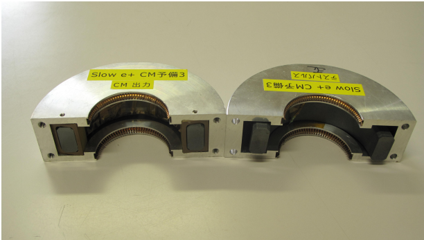
図4 二分割構造によるCM。左半分: コイルを巻いた信号出力部、右半分: テスト入力部。
