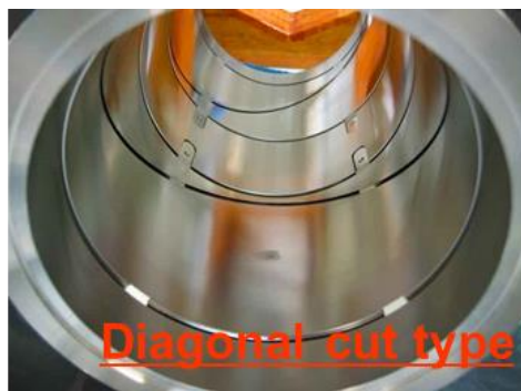
Fig. 4-6 MR 用 Diagonal Cut BPM の電極。ボア径 130 mm が標準サイズで、その他ビームダクトに合わせて 134、165、200、250、320 mm サイズがある。
