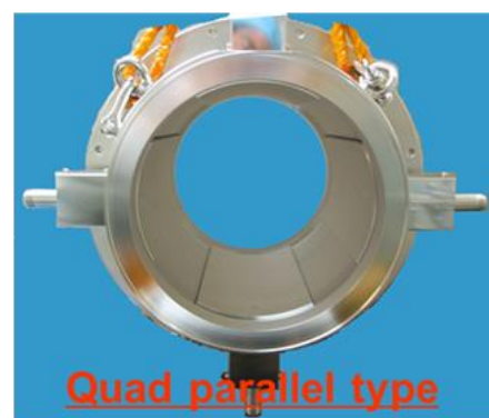
Fig. 4-3 350BT で使用しているストリップライン型 BPM (シングルパス BPM)。ボア計は 230 mm、20 0mm の 2 種類である。
