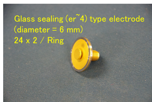
図 15: SuperKEKB 用ガラス封止フィードスルー
