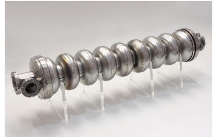
マイクロ波で誘起された電場の静電力で加速
