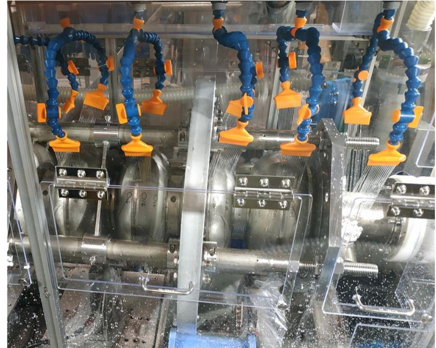
Nb空洞のSRF性能を引き出すには低温EPが適している
