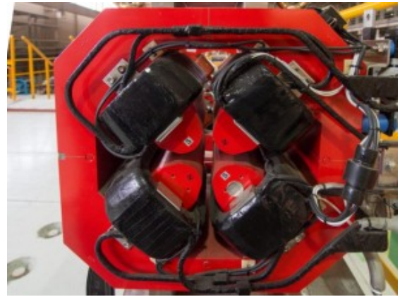
図 9 常伝導電磁石の例 (四極電磁石)
