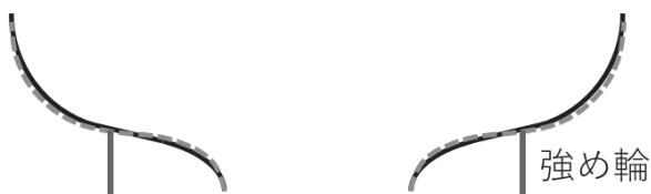
Fig. 38 アイリス溶接後の歪み。実線が溶接前、点線が溶接後のハーフセル形状を示す。
