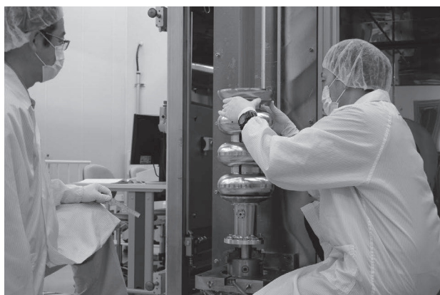
Fig. 39 赤道溶接時の組み立ての様子。
