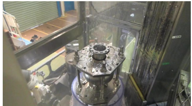
Fig. 45 超純水(比抵抗: ~18.2 MΩcm)による Nb 空洞の高圧洗浄。
