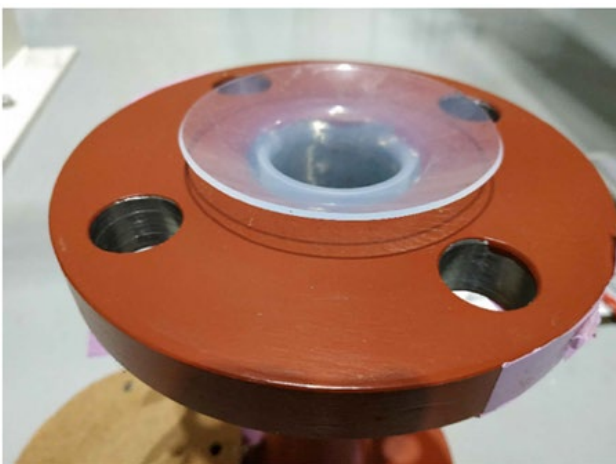
Fig. 12 EP 液用の鋼管. 中にテフロンの内管が入っている.
