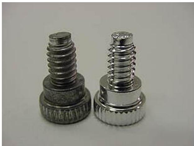
Fig. 4 EP 処理前(左), 後(右)のネジ. 文献[5]より.
