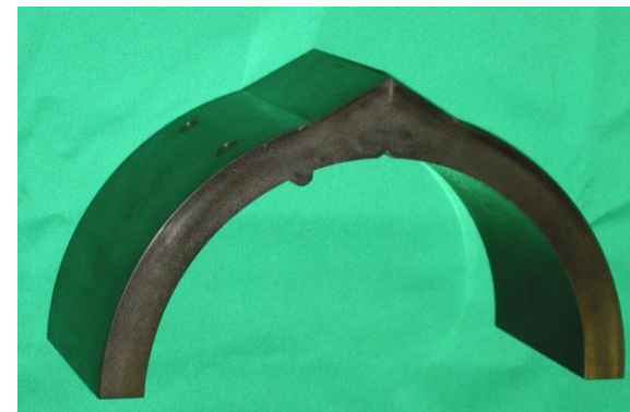
プラスチックカラー ガラス繊維強化フェノール プラスチック(モールディング 成形)
