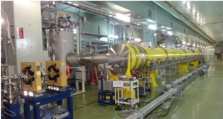
図 11. KEK-SRF 試験施設 (STF). 加速電界 33 MV/m によるビーム加速に成功.
