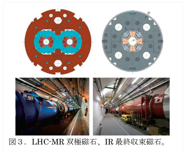
図 3. LHC-MR 双極磁石、IR 最終収束磁石。
