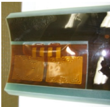
Fig. 3-6 焼損トラブル後に設計変更された QPH
