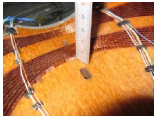
Fig. 4-8 励磁試験後のモデル 1 号機のコイル端部。コイルブロックが 3 mm 変位している様子がわかる。
