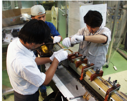
Fig. 2-8 1m モデル磁石試作： コイル巻線
