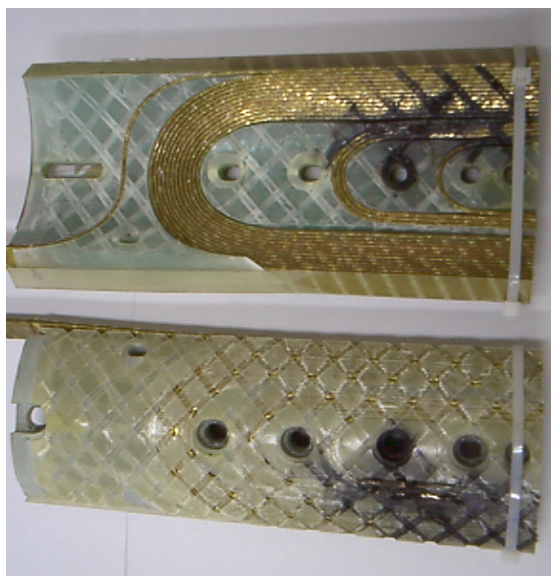
Fig. 2-11 プロトタイプ 1 号機の電気ショートの様子。2 層コイル内周側（上）と 1 層コイル外周側に黒焦げの部分が見える。
