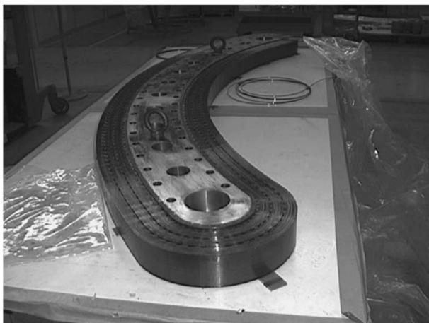
Fig. 18 SRC SBM の超伝導コイルの仕上がり<sup>35)</sup>
