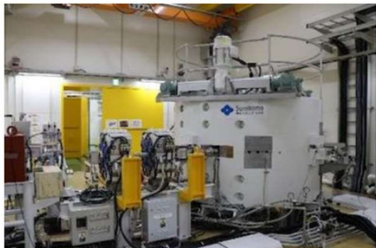
超伝導サイクロトロンの陽子線加速試験の様子 出所：住友重機械工業
