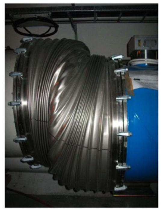
損害：300MJ近いエネルギーが放出：十数台のmagnetが損傷
