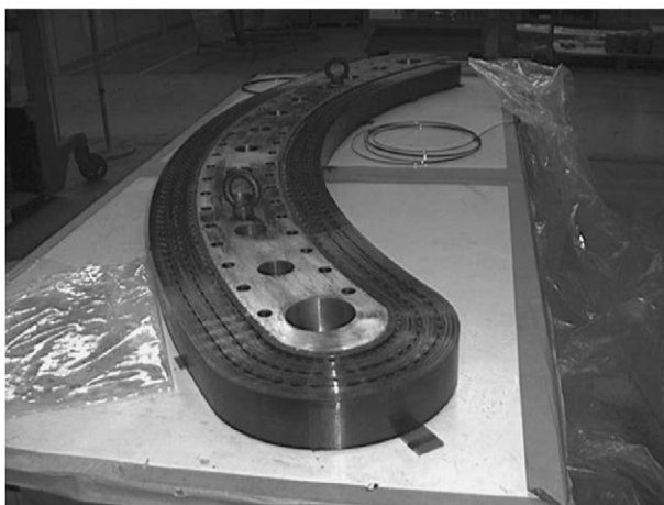
Fig. 18 SRC SBM の超伝導コイルの仕上がり 35)
