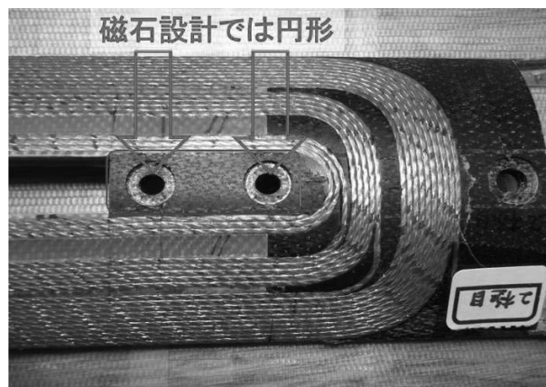
図28 QC1E超伝導コイル端部変形
