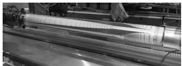
図 37 QCS-L HER ビームライン用 b_3 漏れ磁場キャンセル電磁石
