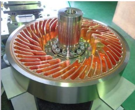
Heガスで最高550rpm (空気最高615rpm) までの高速回転に成功!!
