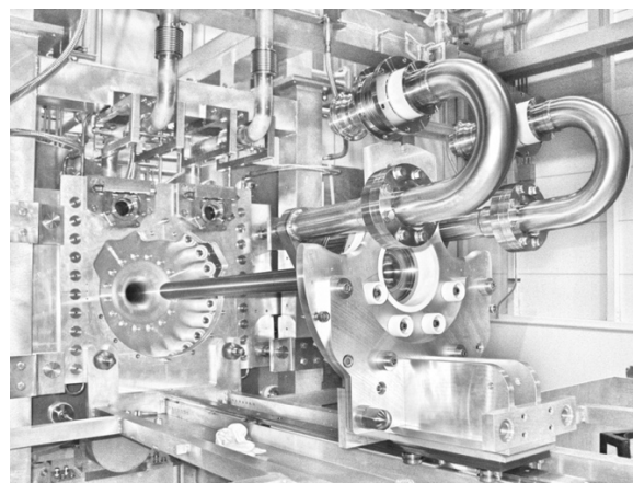
Fig. 3 J-PARC ニュートリノ生成標的 1号機(手前)と電磁ホーン(奥). [6]
