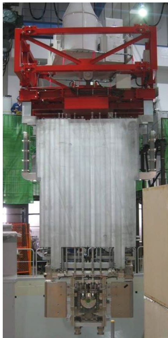
Fig. 26 ハンドリング装置に吊られた第1電磁ホーンと支持モジュール
