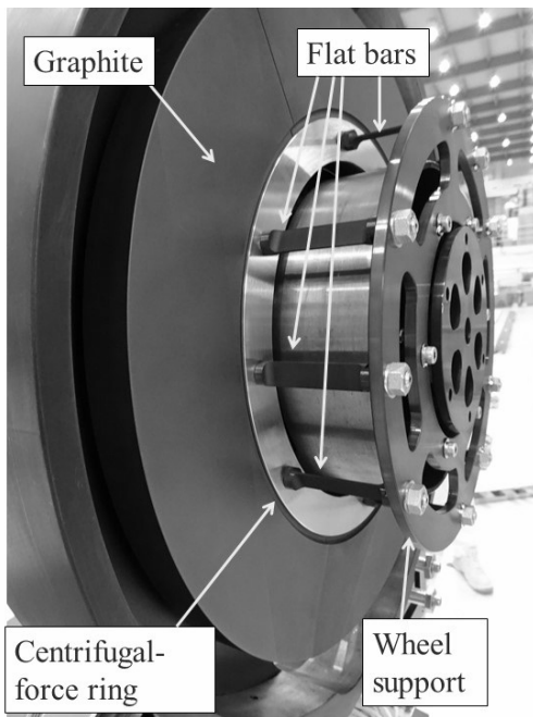
Fig. 10 上：回転標的全体図。標的ロッドが上下移動用スライドテーブル付きのプラグシールドに設置されている。下：回転標的黒鉛部 三分割された黒鉛リングをフラットバーと遠心リングで支持
