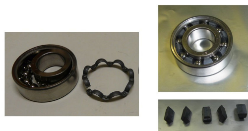
Fig. 13 軸受けの写真。左：従来の固体潤滑剤を利用した軸受ではボール、外輪、内輪、ボールの保持器に二硫化モリブデンや銀をコーティング。右上：二硫化タングステン固体潤滑剤軸受け。右下：二硫化タングステン固体潤滑剤の塊(右下)
