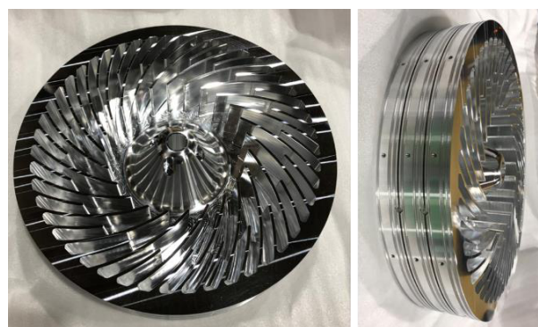
Fig. 17 冷却効率測定のためのターボフィン型回転標的模型の写真。
