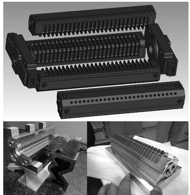
図 4 縦方向分割方式による加速管製作の例 (CLIC 用 X バンド高電界加速管の場合)。
