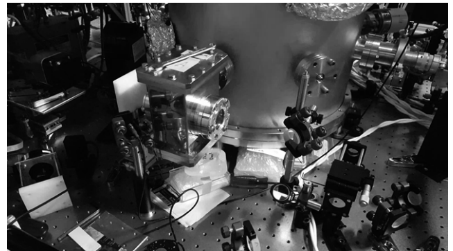
図 32 THz 差周波発生のための MgO:PPLN の冷却チャンバー
