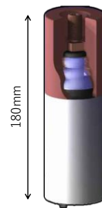
Fig. 6 National ELECTRONICS 製イグナイトロンスイッチ (NL7703EHV)
