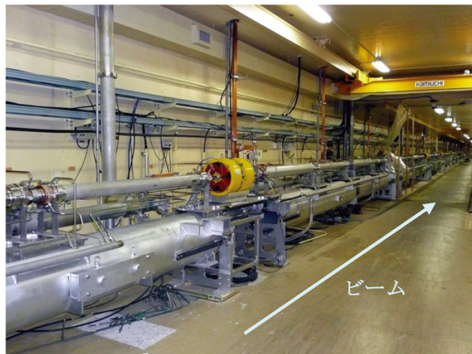
KEK電子陽電子入射器 (2856MHz~10.5cm、 Disk Loaded Traveling-wave LINAC)
