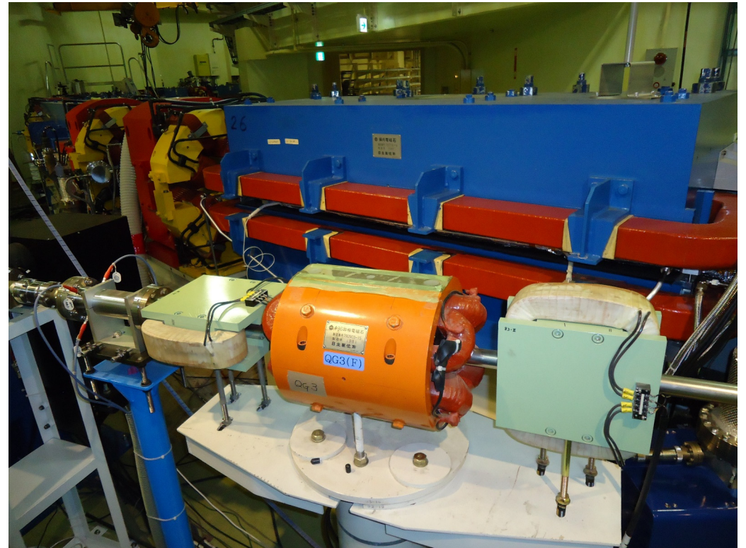
HD - QM - VD 水平補正用2極、4 極、垂直補正用2極
