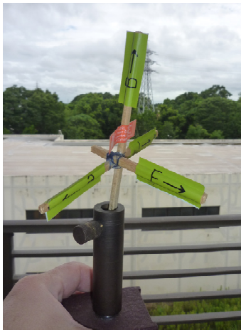
Fig. 10.9 磁場チェック用「フレミングの左手君」 (PF 用に 1 個、cERL 用に 1 個作って置いてある。)
