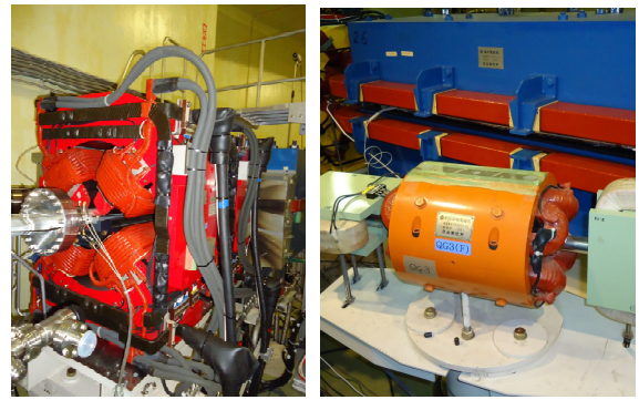
Fig. 10.11 PF の 4 極電磁石。(左：リング主 4 極電磁石、右：ビーム輸送路 4 極電磁石。)
