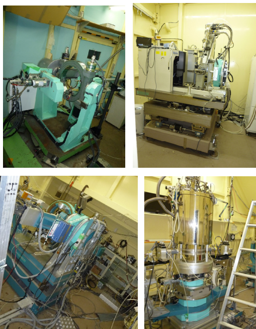
Fig. 6.5 回折、散乱実験装置：4 軸回折計 (BL10A、左上)、極限環境下单結晶構造解析 (ガス吹き付け装置付き、BL8A、右上)、極限環境下測定 4 軸回折計 (BL3C、左下)、超伝導電磁石磁場下单結晶構造解析 (BL3C、右下)
