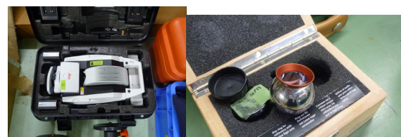
Fig. 10.30 レーザートラッカー (左) とキャッツアイ (右)
