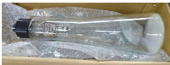
Fig. 2.5 光源系でインターン実習等で利用している陰極線管
