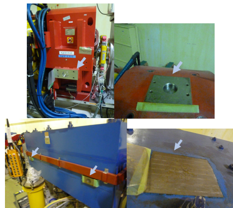
Fig. 10.27 電磁石本体のターゲット座 (上は 4 極電磁石、下は偏向電磁石、左は側面、右は上面。)
