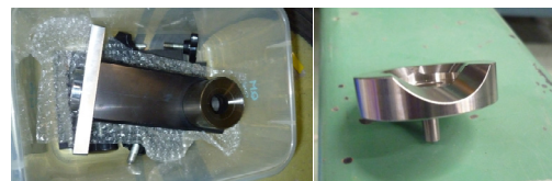
Fig. 10.28 ターゲットを載せるアーム (左) とホルダ (右) (アームは 4 極側面用で 10 cm 球面ターゲット用、ホルダはトラッカーのキャッツアイ用のサイズ。)
