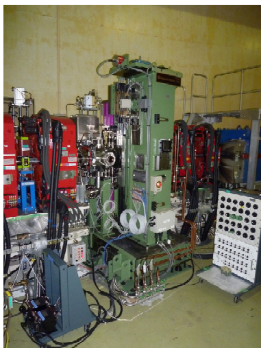
Fig. 5.3 ID15 真空封止短周期挿入光源
