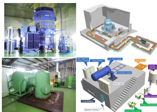
Fig. 8.6 電子線照射装置とプラントの例（上：EPS-5000（5 MeV、20 mA）、下：EPS-1000（1 MeV、100mA）NHV 株式会社「スキャン型電子線照射装置」より。）
