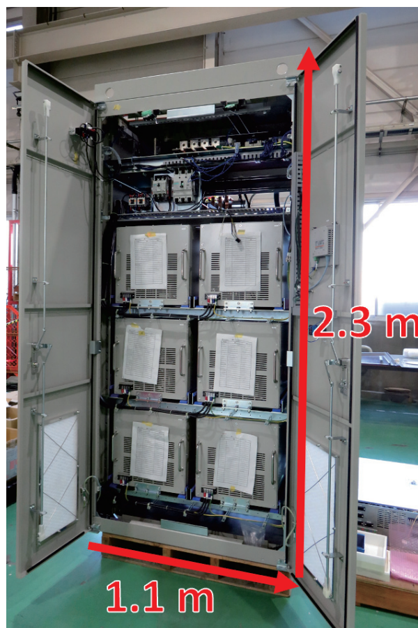
Fig. 27: PF 四極/六極電磁石用新電源の写真。
